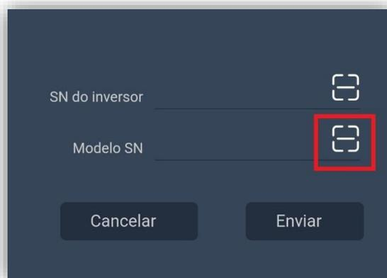
Figura 15 – Botão para scan do SN do datalogger
